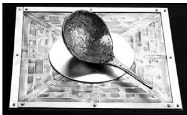
Рис. 1. Китайский компас в виде ложечки из магнетита, помещённой на бронзовую пластину (220 г. до н. э.). Квадрат символизирует Землю, круг в центре — небеса. В центре круга часто изображали Большую Медведицу.
