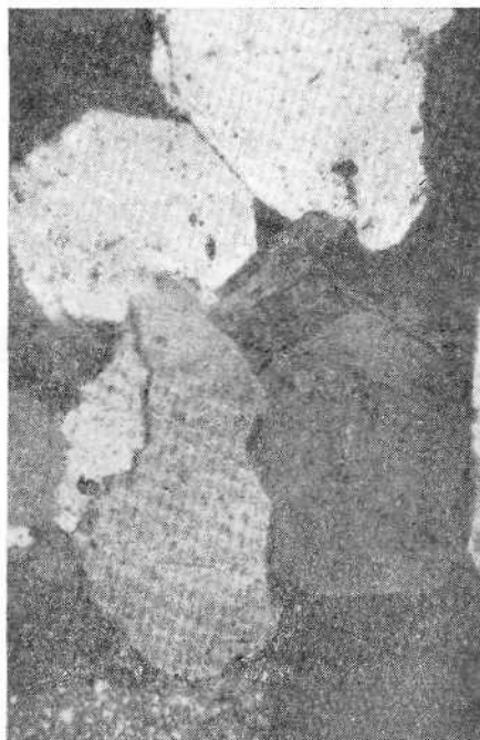
Рис. 9. Песчаник полевошпатово-кварцевый с примесью обломков пород. Цемент глинистый, контактно-порового типа. Фонарская свита, р. Вулан, обн. 2227 обр. 455. Ник. 11, \times 50 .
