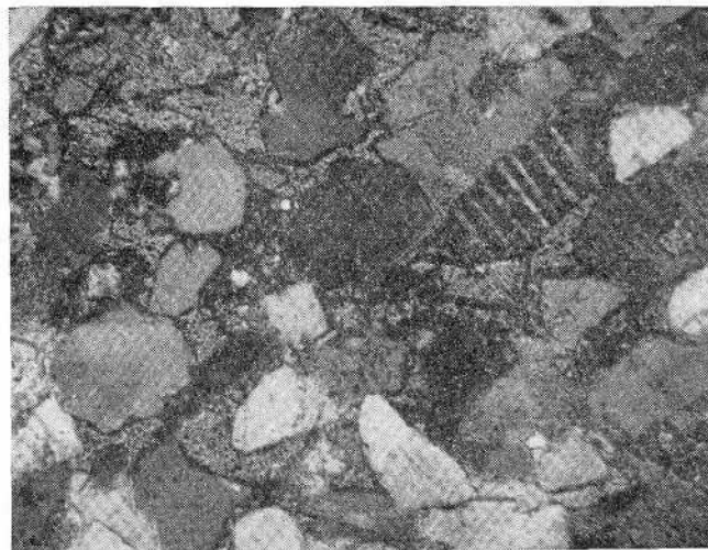
Рис. 10. Песчаник полевошпатово-кварцевый с микрозернистым известковым цементом. Афипская свита, р. Михале, обн. 2059а, обр. 52, Ник. +, \times 50 .
