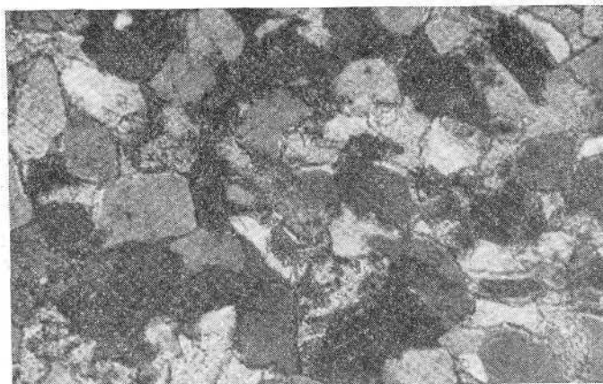
Рис. 5. Песчаник полевошпатово-кварцевый, с известковистым цементом коррозионно-базального типа. Свита чепсы, р. Пишиш, обр. 79 е-4-590, нит. 11, \times 50 .
