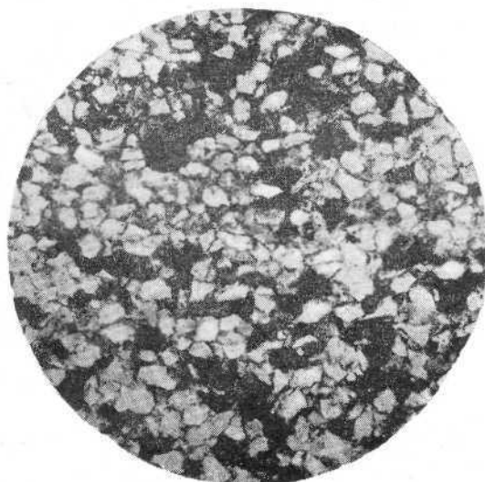
Рис. 14. Глауконитово-кварцевый алевролит, сцементированный глауконитово-глинистым цементом. Альб. Сердюковская скв. 27, гл. 2719—2726 м. \times 30 . Ник. 11.
