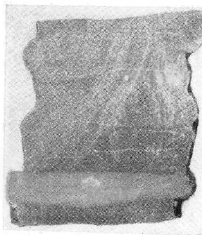
Рис. 5. Прослой сидерита в тонкоотмученной глине. Баррем. Безводная скв. 860, гл. 1861—1863 м. Аншлиф. Натуральная величина.
