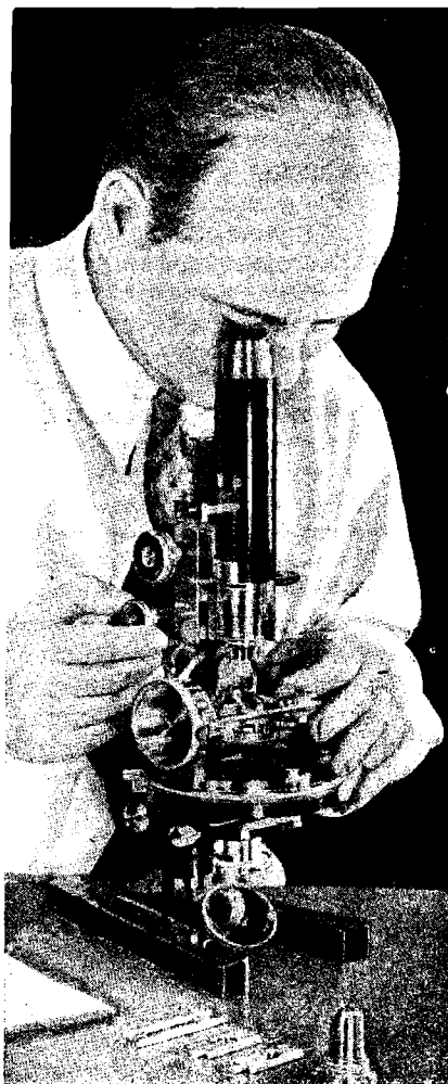
Современный поляризационный микроскоп.
