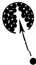
Разрушение атома урана медленным нейтроном.
