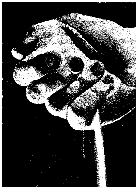
Морской песок из мелких кристаллических зерен кварца. Особо чистый идет на изготовление кварцевого стекла.
