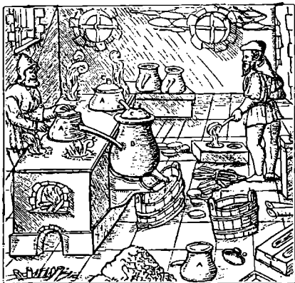
Выплавка серы в средние века.
