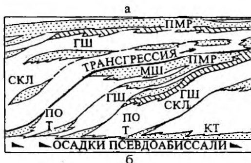
Рис. 1.23. Принципиальная схема формирования покровных и полосовидных песчаных тел [Сейсмогеологический прогноз..., 1992]:
