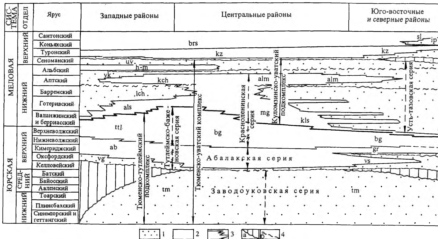
Рис. 1.2. Принципиальная схема взаимоотношения мегакомплексов, подкомплексов, серий и свит в разрезе мезозойских отложений Западной Сибири. Составитель Ю. Н. Карогодин (1970 г.) [1974]:
