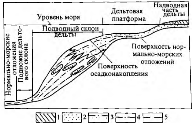
Рис. 1.25. Схематический продольный разрез дельтовой области [Кулахметов и др., 1983]:
