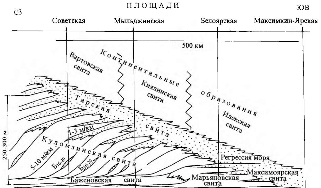
Рис. 1.5. Принципиальная схема формирования разреза верхнеюрско-валанжинских отложений в юго-восточной части Западно-Сибирской равнины [Наумов, 1977].
