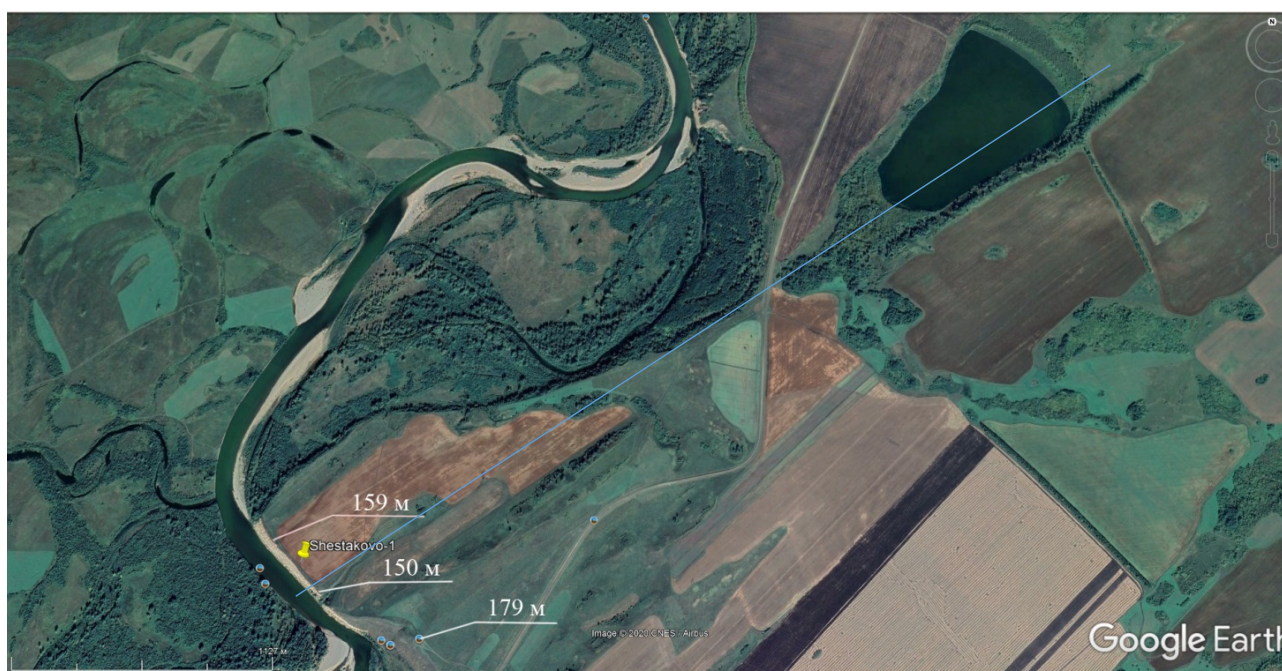
Рис. 40. Балка, разделяющая Шестаковский яр, тыловой шов оползня (синяя линия)
