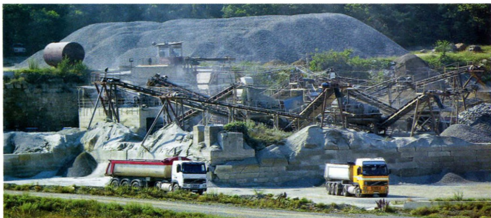
Рис. 42. Дробилка, на которой приготавливают щебень из габбро-диоритов Первомайского интрузива. Река Бодрак. Фото В.В. Аркадьева ▼
