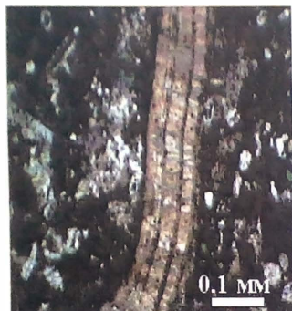
Рис. 4.4. Органогенно-уламковий вапняк шаруватої мікротекстури з фрагментами водоростей (а) та колоніальних організмів (б).
